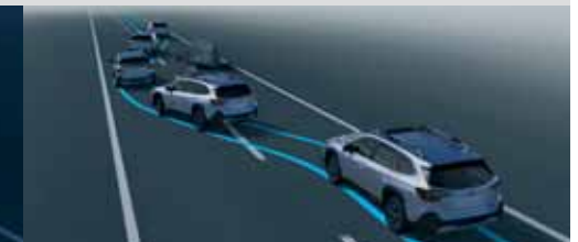
Система автоматичного гальмування під час руху заднім ходом Reverse Automatic Braking (RAB)*2
