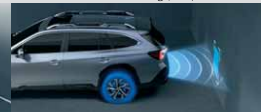
Система автоматичного гальмування під час руху заднім ходом Reverse Automatic Braking (RAB)*2
