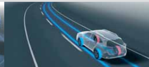
Система активного розподілу крутного моменту Active Torque Vectoring
