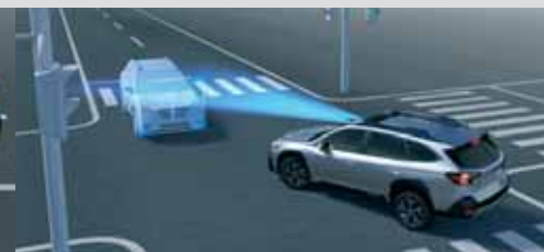
Система передаварійного гальмування Pre-Collision Braking System
