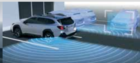
Система контролю «сліпих» зон Subaru Rear Vehicle Detection (SRVD)*2
