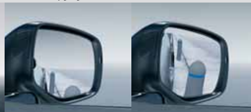
Система контролю «сліпих» зон Subaru Rear Vehicle Detection (SRVD)*2
