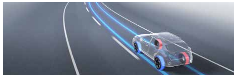
Активний вектор тяги (система активного розподілу крутного моменту)
