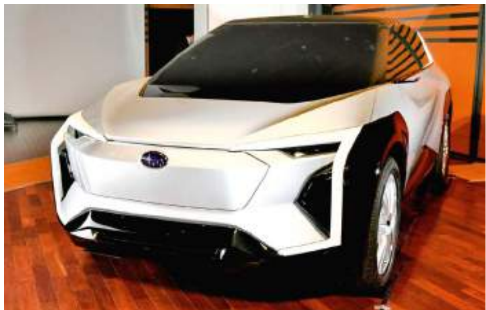
■ Електрокар Subaru: Перший прототип електрокара Subaru на платформі e-TNGA, яка розробляється спільно з Toyota
